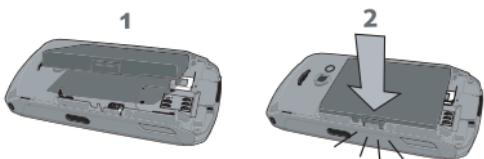
如下圖所示，裝回背殼：將背殼鉤上手機頂端的鎖扣，然後壓下背殼底端，直到彈簧鎖扣好為止。
