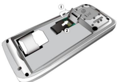
ادفع حامل البطاقة إلى أسفل، ثم ارفعه إلى أعلى. قم بمحاذاة بطاقة SD-micro مع الفتحة. وضعها في مكانها الصحيح. اضغط على حامل البطاقة إلى أسفل وقم بسحبه حتى يتم غلقه. لتحويل الملفات من الكمبيوتر، استخدم قارئ بطاقات متواافق.
