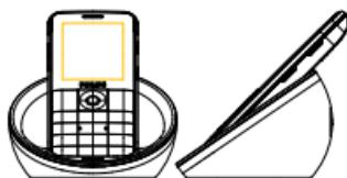
您在将手机放入充电底座时，需对准插槽及充电弹片。
