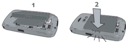
Coloque novamente a tampa traseira, como ilustrado abaixo: encaixe a parte de cima do telefone no gancho e em seguida empurre a parte de baixo para dentro até a lingueta engatar.
