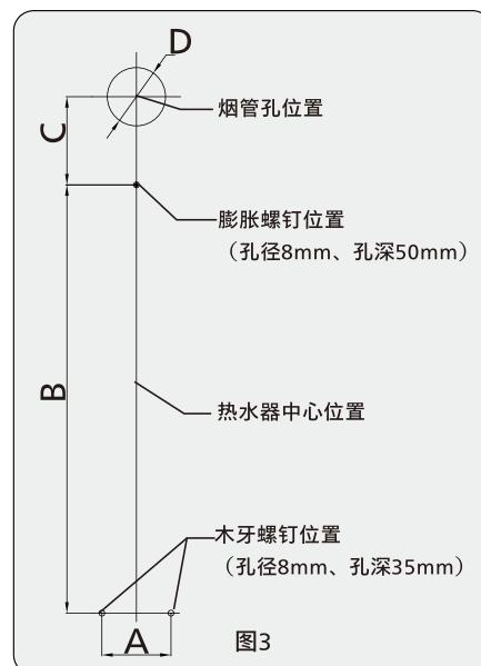
4、烟管向后面的安装方法：将排烟管插入钻好的烟管安装孔内，排烟口向外，然后将弯头插入热水器的出烟口，再整体把弯头的另一端对准装好的排烟管向后移使弯头插入排烟管。
