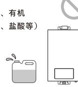
请勿将热水器安装在浴室内。请勿将热水器安
