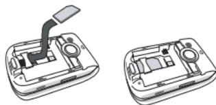
4. Placez la batterie en la faisant glisser et appuyez sur le bas jusqu'à fixation (les connecteurs doivent être en contact avec les connecteurs du téléphone).
