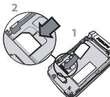
4. 插入電池：首先將電池的右側（接口朝下）靠著手機的右側，然後壓下直到它扣入為止。
