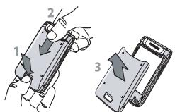
2. 如圖所示，利用黑色的凹槽向右邊提起電池，以將它移除。
