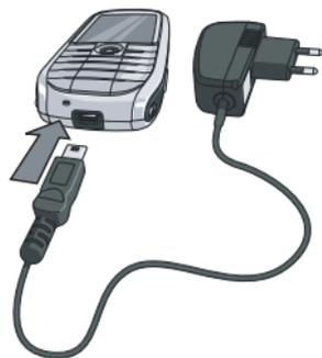
Biểu tượng pin sẽ cho biết tình trạng pin sạc. Trong khi sạc pin, 4 vạch pin chỉ báo cuộn lên xuống; thời gian sạc cho pin trống là 3 giờ đối với bộ sạc chuẩn. Khi bốn vạch chỉ báo đều dừng lại thì pin đã được sạc đầy. Sau đó bạn có thể ngưng kết nối bộ sạc. Tùy vào mạng và điều kiện sử dụng, thời gian trò chuyện có thể lên đến 4 giờ và thời gian chờ có thể lên đến 300 giờ.
