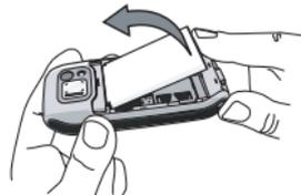
Nếu thẻ SIM được giao cho bạn với kích thước bằng thẻ tín dụng, hãy lấy thẻ SIM ra khỏi giá đỡ và lắp nó vào dưới kẹp giữa kim loại cho đến khi nó dừng hẳn. Hãy chắc chắn rằng góc kẹp của thẻ phải nằm đúng vị trí và các điểm tiếp xúc màu vàng phải quay xuống phía dưới.
