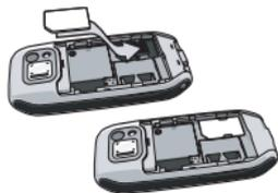
Trượt pin trở lại ngăn chứa pin với các khớp nối kim loại quay xuống phía dưới cho đến khi nó dừng hẳn. Sau đó khóa pin lại bằng cách đẩy nó theo hướng đi xuống.
