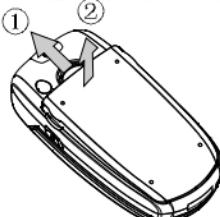
的卡锁①向上拉, 然后拉起电池盖②, 取出电池。
