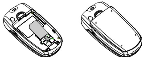
将电池装回, 金属触点向下, 底部对准槽口, 确保卡锁卡住电池。
