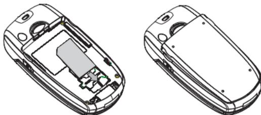
Kembalikan baterai ke slotnya, bagian kontak emas menghadap ke bawah sampai menghentak masuk ke dalam tempatnya.
