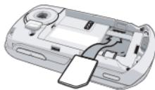
將電池推入電池槽內，直到它停止不動為止，金屬接觸面要朝下。然後，將電池壓下，將它鎖定位置。
