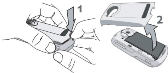
若要將電池取出，壓下彈簧鎖 (1)，然後依圖中所示方向提起電池。
