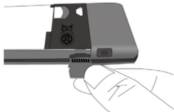
如需取出 Micro SD 卡，按压 Micro SD 存储卡解锁，使其从卡槽中弹出。
