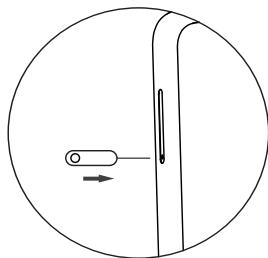
2, 卡针按箭头指示方向插入，轻顶弹片卡托弹出
