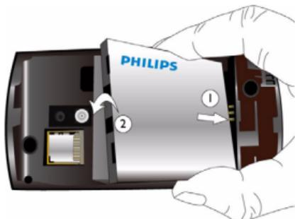
5. 如图示，将后盖对准槽口推入，直至卡定到位。
