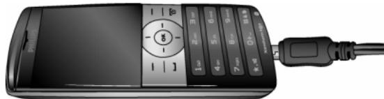
Символ аккумулятора указывает состояние зарядки. Во время зарядки будет отображаться ход процесса. Для полной зарядки аккумулятора понадобится примерно 3 часа. Когда все четыре полоски отображаются постоянно, аккумулятор заряжен полностью. После этого можно отключить зарядное устройство.
