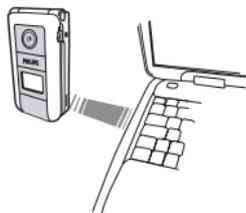
Prima di inviare o ricevere dati da un dispositivo, è necessario che questo sia correttamente posizionato rispetto al telefono cellulare. Assicurarsi che le porte IrDA si trovino una di fronte all'altra e a una distanza di 50 cm (vedere
