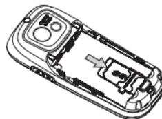
Kembalikan baterai ke slotnya, bagian kontak emas menghadap ke bawah sampai menghentak masuk ke dalam tempatnya.
