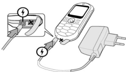
1. Una vez que la batería y la tapa de la batería estén colocadas en el teléfono, enchufe el extremo del conector del cargador (suministrado con el teléfono, en la caja) a la toma de la IZQUIERDA de la base del teléfono y, a continuación, enchufe el otro extremo a una toma de corriente de CA de fácil acceso.
