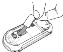
3. Deslice la batería en su ranura, con los conectores metálicos hacia abajo, hasta que haga tope. A continuación, fíjela empujando hacia abajo.
