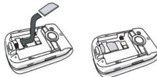
4. Sisipkan baterai dengan menggeser dan mendorongnya ke bawah (konektor menghadap ke konektor telepon).
