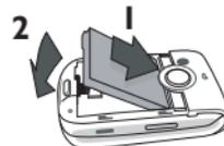
5. Tutup kembali wadah baterai dengan menyorong penutup ke dalam slotnya, sampai berhenti. Lepaskan film pelindung yang menutupi layar sebelum menggunakan telepon.
