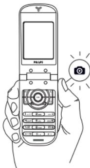
Untuk semua modus lainnya, pegang ponsel secara vertikal dan tekan
