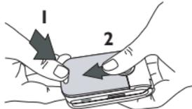
2. Keluarkan baterai dengan mengangkat baterai dengan pegangannya (grip) seperti ditunjukkan pada gambar di bawah ini.
