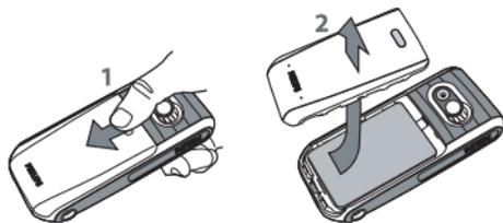
2. Nếu cần, hãy tháo pin ra: nhấn kẹp gài bên trong xuống, sau đó tháo pin bằng cách kéo nó ra từ phần dưới.
