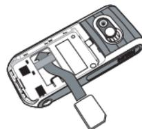
4. Trượt nắp pin trở lại theo khe, với các phần tiếp xúc bằng kim loại hướng xuống, cho đến khi ngừng hẳn. Sau đó khóa lại bằng cách nhấn nắp xuống.
