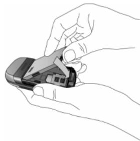
Установите заднюю крышку, вдвинув ее в пазы до упора.
