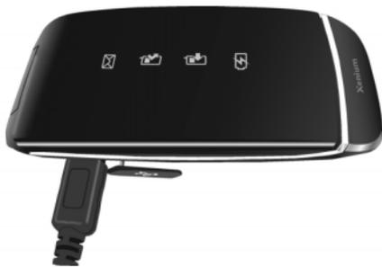
O símbolo da bateria indica o estado da carga. Durante o carregamento, os indicadores de carga irão deslocar-se; são necessárias cerca de 3 horas para carregar totalmente a bateria. Assim que todas as barras fixarem, a bateria estará totalmente carregada. Pode depois desligar o carregador.
