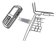
向另一设备发送或从另一设备接收数据前，必须正确定位设备：确保他们各自的 IrDA 端口如图那样对准，且两者相距不超过最大距离 50 厘米。还要确保没有任何东西阻挡 IrDA 光束。
