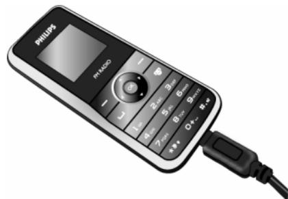
Pendant la charge, l'indicateur de charge s'anime. Une charge complète demande environ 3 heures. Lorsque toutes les barres de l'indicateur sont fixes, la batterie est complètement chargée. Vous pouvez alors débrancher le chargeur.
