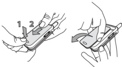
2. Retire la batería presionando las pestañas interiores una tras otra y levante la batería desde el lado izquierdo.
