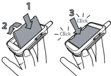
5. Introduzca la batería con los conectores hacia abajo en el compartimento de la batería hasta el tope.
