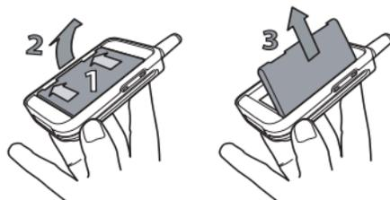
3. Retire la tarjeta SIM de su soporte y colóquela en su ranura (asegúrese de que la esquina recortada de la tarjeta se coloca en la esquina adecuada). Empuje la fijación de plástico que sujeta la tarjeta SIM hasta el tope.
