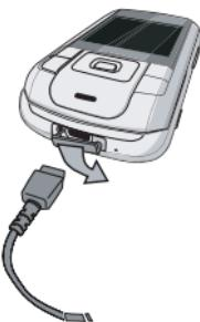
Biểu tượng pin sẽ cho biết tình trạng pin sạc. Trong khi sạc pin, 4 vạch pin chỉ báo cuộn lên xuống; thời gian sạc cho pin trống là 3 giờ đối với bộ sạc chuẩn. Khi bốn vạch chỉ báo đều dừng lại thì pin đã được sạc đầy. Sau đó bạn có thể ngưng kết nối bộ sạc. Tùy vào mạng và điều kiện sử dụng, thời gian trò chuyện có thể lên đến 4 giờ và thời gian chờ có thể lên đến 300 giờ.
