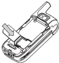
3. 將電池的金屬觸點朝下並插入電池槽中，直至固定為止。然後按下電池，將電池卡住。
