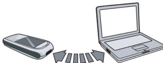
Untuk mengaktifkan transmisi infra merah, tekan **Menu > Konektivitas > Infra merah**. Pengguna telepon yang mengirim, memilih fungsi IR yang dikehendaki untuk memulai transfer data.
