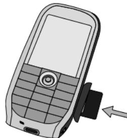
*Untuk mengeluarkan kartu mini-SD, tekan kartu ke bawah ke dalam slot dan lepaskan. Kartu akan terlontar keluar slot.*
