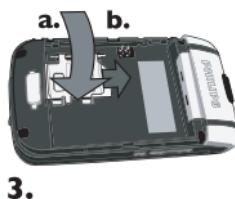
Вставьте аккумулятор в отсек позолоченными контактами вниз. Затем зафиксируйте ее, втолкнув вниз до упора. Установите заднюю крышку, вставив ее в пазы до упора.
