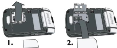
Закройте держатель карты и сдвиньте его в фиксированное положение.
