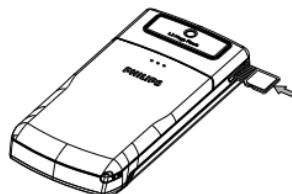
3. 如果您需要移除存储卡，请先向槽内轻推存储卡，稍后存储卡将会自动弹出。
