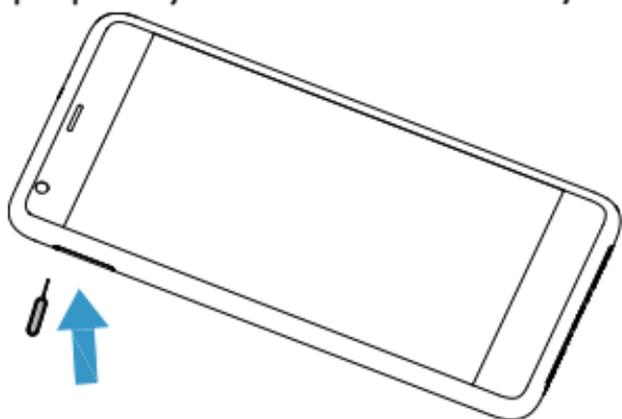
Coloque la tarjeta SIM: El dispositivo permite dos SIM en modo de espera pero solo una SIM en operación en cualquier momento.
