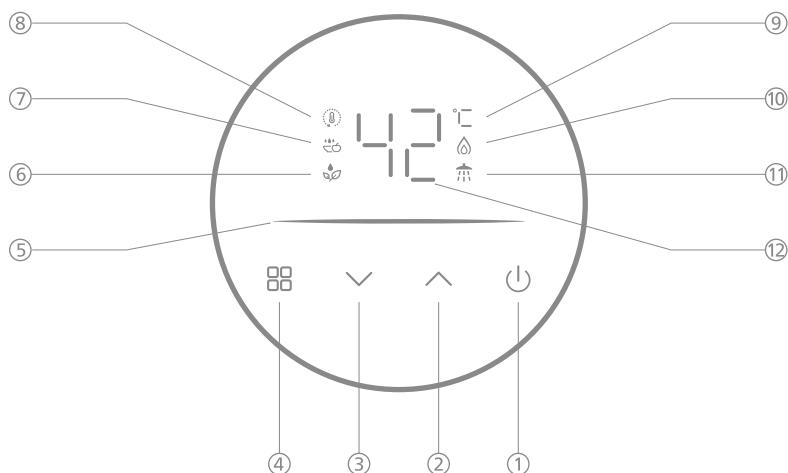
图标1. (1)：待机键上电后, 按此键可在开机和待机之间切换, 当系统出现故障时, 按此键, 可以清除故障代码。
