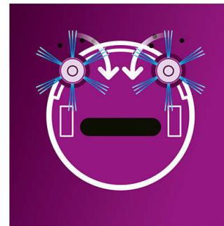
Сначала две длинные щетки направляют грязь и пыль по траектории движения робота-пылесоса. Затем насадка собирает всю пыль и грязь благодаря мощному мотору. В конце съемная насадка для салфеток тщательно собирает самую мелкую пыль, улучшая результат уборки.
