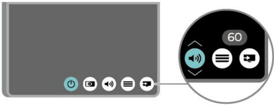
3 - Pulse arriba o abajo para ajustar el volumen o sintonizar el canal siguiente o anterior. Pulse arriba o abajo para desplazarse por la lista de fuentes, incluida la selección del sintonizador.
