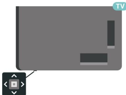
1 - Con el televisor encendido, pulse el botón con el símbolo de joystick en la parte inferior del televisor para ver el menú básico.
