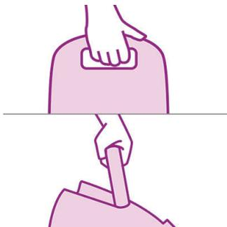
Cet aspirateur est équipé non pas d'une, mais de deux poignées de transport. Lorsqu'il est posé sur ses roues, la poignée située sur le dessus de l'appareil vous permet de déplacer l'aspirateur presque sans vous pencher. La deuxième poignée est placée à l'avant et vous permet de transporter facilement l'aspirateur en position verticale.
