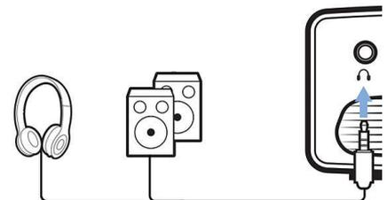
Verbinden Sie Kopfhörer oder Lautsprecher mit externer Stromversorgung über die integrierte 3,5-mm-Buchse.
