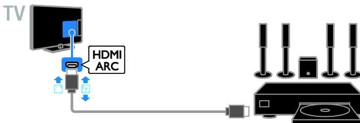
Schließen Sie das Home Entertainment-System über ein HDMI-Kabel und ein koaxiales Audiokabel am Fernseher an.
