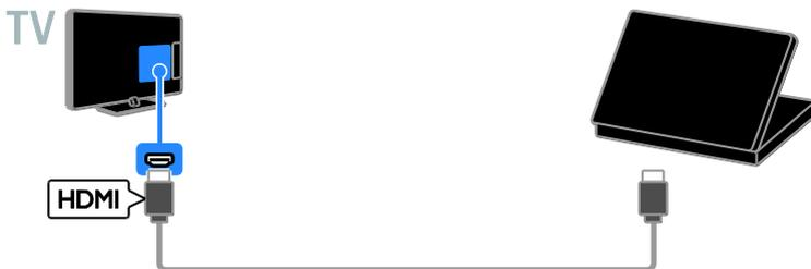
Schließen Sie den Computer über ein DVI-HDMI-Kabel und ein Audiokabel am Fernseher an.
