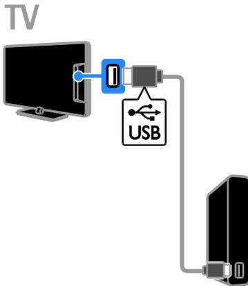
Schließen Sie die USB-Festplatte über ein USB-Kabel am Fernseher an.
