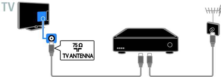
Schließen Sie den Satelliten- bzw. Digital-Receiver über ein HDMI-Kabel am Fernseher an.
