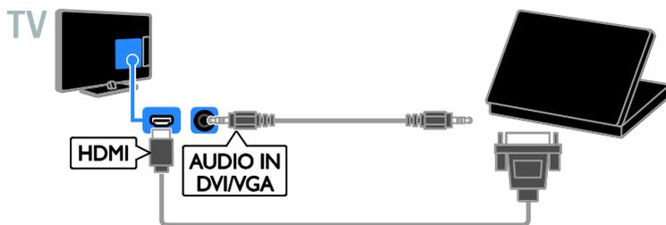
Schließen Sie den Computer über ein VGA-Kabel und ein Audiokabel am Fernseher an.
