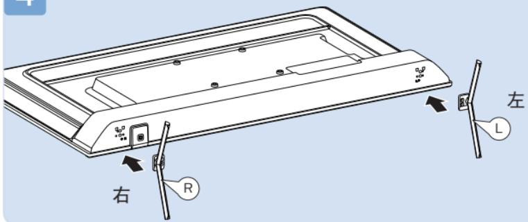
\*将底座按照图示对齐放置(注意区分左右支撑), R、L在底座上有标识； 7
