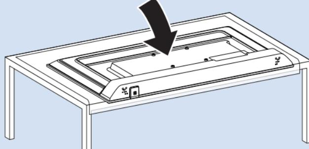
\*请将电视机底部边缘靠近台面边缘，将下巴放置于台面外约5cm。
