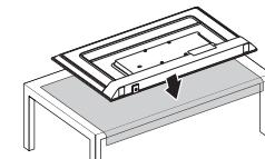
\*请将电视机底部边缘靠近台面边缘，将下巴放置于台面外约5cm。
