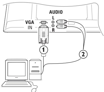
❶ Koble den ene enden av VGA kabelen ① til videokortet på datamaskinen og den andre enden til **VGA IN** kontakten i bunnen på TV-en. Fest pluggene forsiktig til kontaktene med skruene på pluggene.
