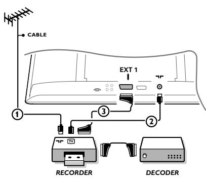
Antennekablene ① og ② tilkobles som vist på tegningen ved siden av. Bildekvaliteten kan forbedres hvis man også tilkobler en eurokabel ③. Hvis videomaskinen din ikke har noen eurotilkopling, kan den utelukkende tilkoples over en radiobølgekabel. Det vil da være nødvendig å stille inn testsignalet på videomaskinen og å anvende det på program nummer 0 eller å lagre testsignalet under et programnummer mellom 90 og 99, se Manual lagring, s.7. Se håndboken for oppakeren.
