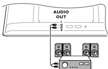
For å koble til et stereoanlegg bruker du audiokabel. Kabelen skal gå mellom **L** og **R**-utgangene på TV-apparatet og inngangen **AUDIO IN L** og **R** på stereoanlegget.
