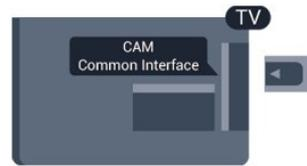
استخدم فتحة الواجهة المشتركة على التلفزيون لإدخال بطاقة وحدة CAM. مع توجيه الجهة النهائية للبطاقة نحو، أدخل بطاقة وحدة CAM بتأن إلى أبعاد حد ممكن أن تصل إليه. اترك البطاقة في فتحتها بشكل دائم.
