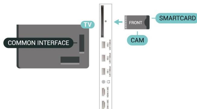
Lorsque vous allumez le téléviseur, l'activation du module CAM peut prendre quelques minutes. Si un module CAM est inséré et l'abonnement payé (les méthodes d'abonnement peuvent varier), vous pouvez regarder les chaînes cryptées prises en charge par la carte à puce CAM.
