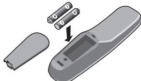
Włożyć 2 dostarczone baterie R6, zachowując właściwą polaryzację.
