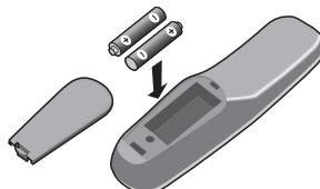
Helyezze be a 2 darab mellékelt, R6 típusú elemet, ügyeljen az elemek polaritására (+/-).
