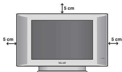
Televízor umiestnite na pevnú a stabilnú plochu. Aby sa zabránilo možným nebezpečným situáciám, televízor neumiestňujte do blízkosti striekajúcej vody, k zdroju tepla (lámpa, sviečka, radiátor atď.) a nezakrývajte vetracie mriežky umiestnené vzadu.
