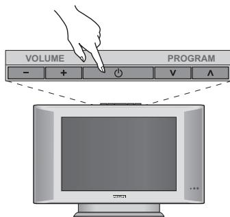
Televizi zapnete stisknutím tlačítka pro zapnutí a vypnutí. Rozsvítí se zelená kontrolka a rozjasní se obrazovka. Přejděte nyní ke kapitole popisující **rychlou instalaci**. Zůstane-li televizor v pohotovosti (červená kontrolka), stiskněte tlačítko P (+) dálkového ovládače.
