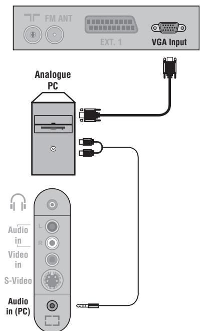
Csatlakoztassa számítógépe monitor kimenetét televíziókészüléke **PC VGA In** bemenetéhez. Csatlakoztassa számítógépe **Audió out L** és **R** kimenetét televíziókészüléke **Audió in (PC)** bemenetéhez.
