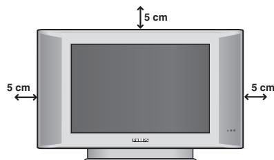
Установите телевизор на твердой устойчивой поверхности. Во избежание возникновения опасных ситуаций не допускайте попадания на телевизор воды, воздействия на него источников тепла (ламп, свечей, нагревательных приборов и т.д.) и не закрывайте вентиляционные решетки, расположенные на задней панели.
