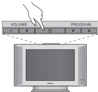
Televízor zapnite stlačením vypínača. Kontrolný indikátor zapnutia sa rozsvieti na zeleno a zapne sa obrazovka. Prejdite priamo ku kapitole s informáciami o rýchlej inštalácii na strane 6. Ak televízor zostane v úspornom režime (červený kontrolný indikátor), stlačte tlačidlo P (+) na diaľkovom ovládači. Kontrolný indikátor pri používaní diaľkového ovládania bliká.
