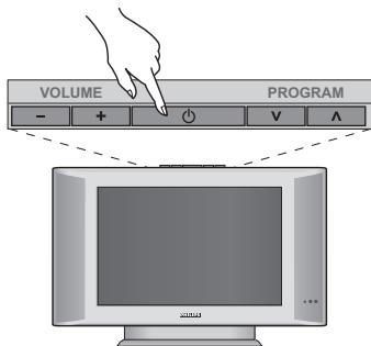
Televizyonunuza açmak için açma kapama tuşuna basın. Açıığınızda yeşil ışık yanacak ve ekran aydınlanacaktır. Direkt olarak sayfa 6'deki hızlı ayarlama bölümüne bakın. Eğer televizyonunuz uykuya halinde duruyorsa (kırmızı ışık), uzaktan kumandanın P + tuşuna basın.
