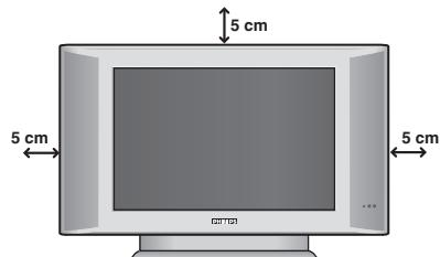
Placez votre téléviseur sur une surface solide et stable. Pour prévenir toute situation dangereuse, ne pas exposer le téléviseur à des projections d'eau, à une source de chaleur (lampe, bougie, radiateur, ...) et ne pas obstruer les grilles de ventilation situées à l'arrière.
