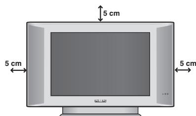
A készüléket stabil, szilárd felületre helyezze. A biztonsági szempontokat figyelembe véve, a készüléket ne tegye vízszigár, hőforrás (lámpa, gyertya, radiátor stb.) közelébe és ne tömítse el a készülék hátoldalán található szellőzőrácsokat.
