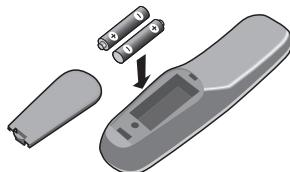
R6 tipindeki 2 pilin kutularına göre uzaktan kumandaya takın. Alet ile verilen piller doğanın korunmasına yardımcı olmak amacıyla nikel ne de kadmium içermektedir. Lütfen kullanılmış pilleri gelişigüzel atmayarak tekrar üretilmesine katkıda bulunmak için belirlenen özel kullanılmış pil kutularına atın.
