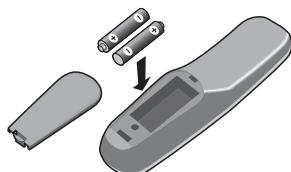
Vložte dve dodávané batérie typu R6, pričom dbajte na ich polaritu.
