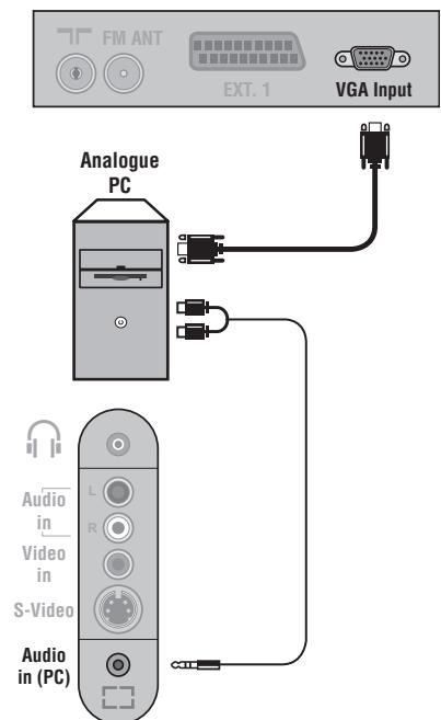
Připojte výstup monitoru vašeho počítače ke vstupu **PC VGA In** televizoru. Spojte výstup pro zvuk **Audio out L a R** počítače se vstupem **Audio in (PC)** televizoru.
