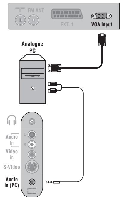
Подсоедините выходной разъем для подключения монитора на компьютере к входному разъему **PC VGA In** телевизора. Подсоедините выходной аудиоразъем **Audio out L** и **R** на компьютере к входному разъему **Audio in (PC)** телевизора.
