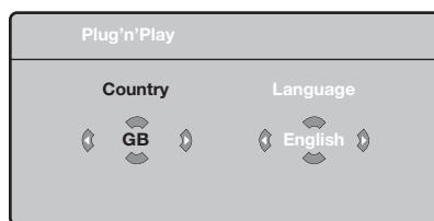
**⚠** Pokud se menu neobjeví, držte pro jeho vyvolání po dobu 5 sekund stisknutá tlačítka ▶+ a ▶- na televizoru.
