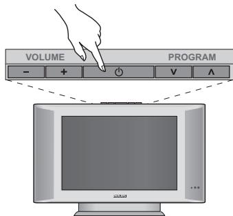
Aby włączyć telewizor, należy nacisnąć przycisk włączania/wyłączania. Zapala się zielona lampka oraz ekran. Instrukcje dotyczące **szkiej instalacji**. Jeżeli telewizor pozostaje w stanie czuwania (pali się czerwona lampka), wystarczy nacisnąć przycisk P + pilota.
