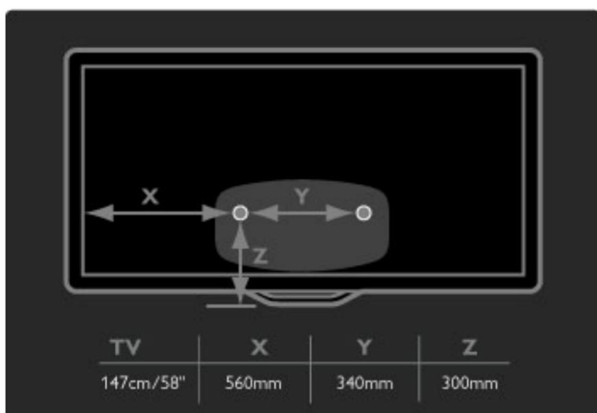
Закрепете двата монтажни диска. Използвайте винтове с диаметър максимум 6 мм.
