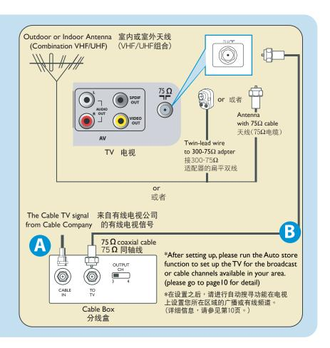
2 Cable Box With Audio / Video Outputs 分线盒 (带有声音/视频输出)
