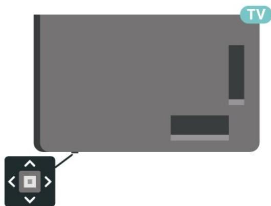
**1** - При включен телевизор натиснете клавиша с джойстик в долната част на телевизора, за да иззвикате базовото меню.
