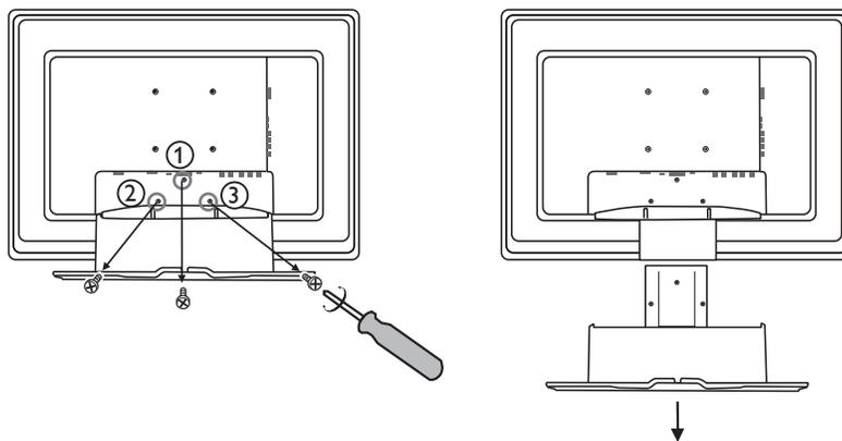
Les 4 trous sur le côté arrière de votre TV LCD se conforment à la norme Vesa.
