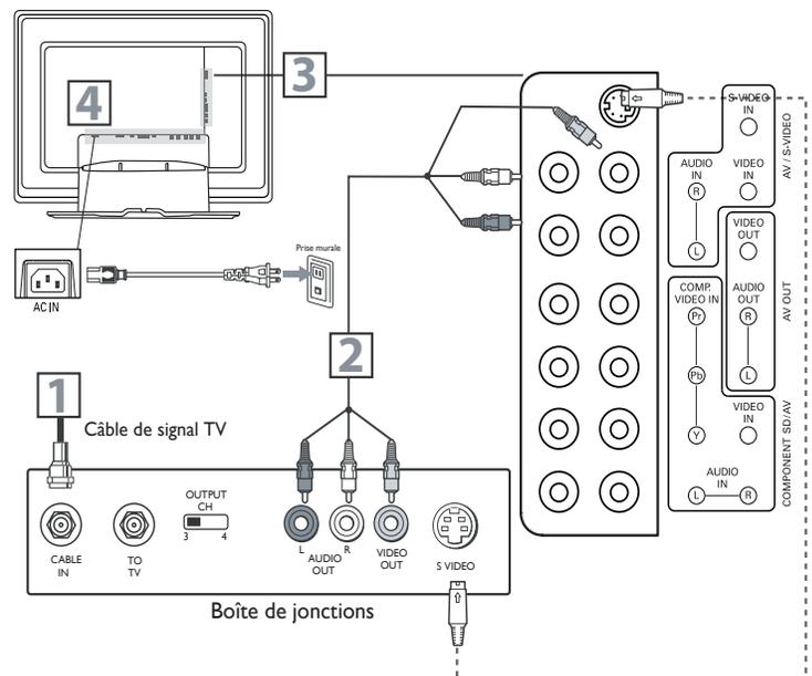
Remarque : Utilisez la touche AV+ sur votre télécommande pour syntoniser au canal AV sur le signal de la boîte de connexion. Lorsque vous regardez des émissions en utilisant le magnétoscope, il est recommandé de sélectionner le mode DOUX via auto-image.
