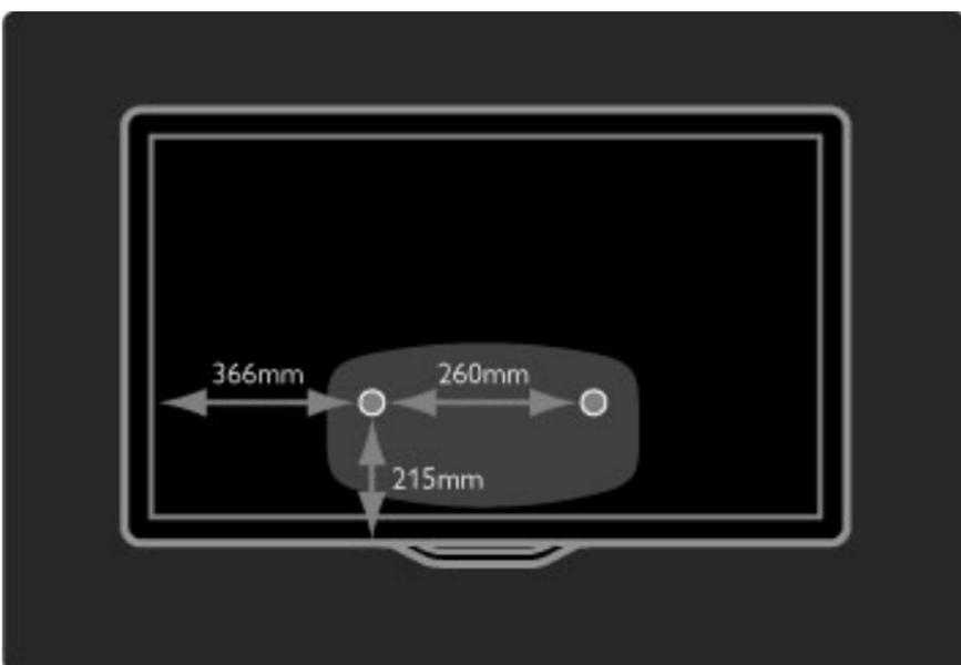
Pritrdite 2 namestitveni ploščici. Uporabite vijake premera do 6 mm.
