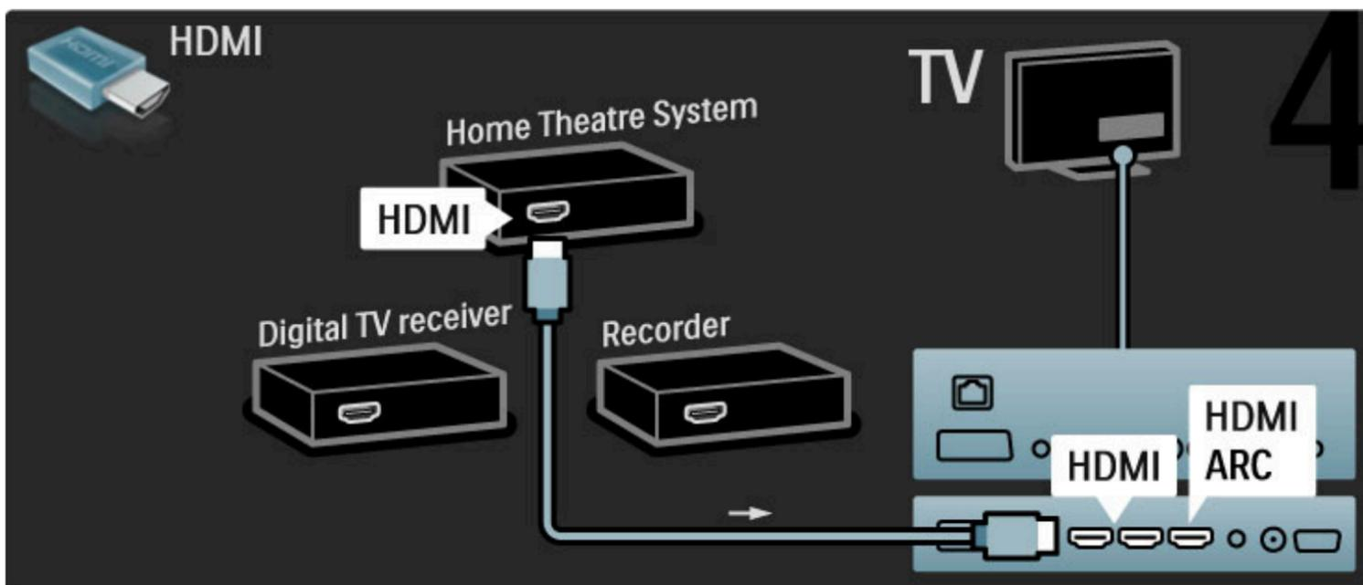
Če na televizorju in napravi ne uporabljate povezave HDMI-ARC, dodajte digitalni avdio kabel (koaksialni s činčem).
