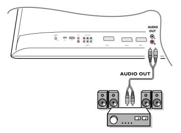
Branchez un récepteur Surround Multicanal analogique aux connecteurs **AUDIO OUT L** et **R** en bas du téléviseur. Le volume doit être réglé via le récepteur Surround Multicanal.
