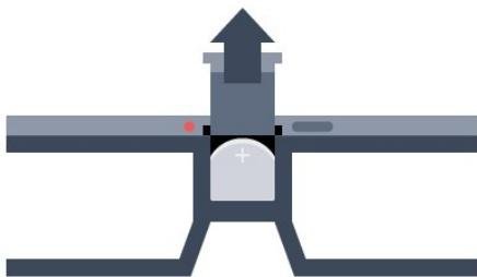
Чтобы заменить батарею, нажмите на небольшую кнопку на крышке отсека для батареи и снимите крышку, сдвинув ее вверх. Установите новую батарею типа CR2032 (3 В). Убедитесь, что видна сторона батареи с маркировкой +. Снова установите и закройте крышку, сдвинув ее вниз.
